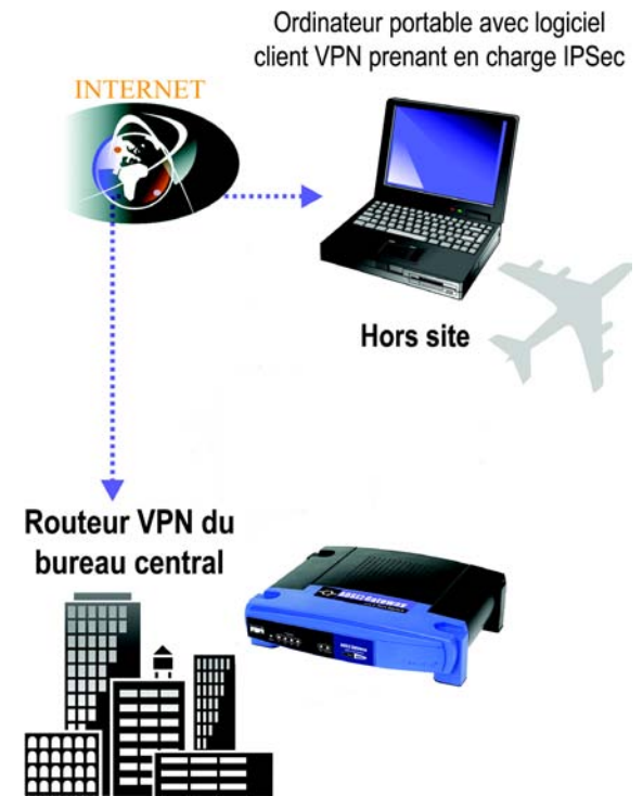
Figure 2-2 : Modem routeur connectant l'ordinateur et le réseau VPN
