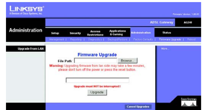
Figure E-1 : Firmware Upgrade (Mise à niveau du micrologiciel)
