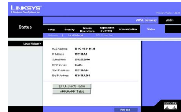
Figure 5-38 : Local Network (Réseau local)
