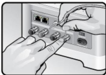
Wenn Sie Lautsprecherkabel verwenden, drücken Sie mit dem Finger den federgelagerten Lautsprecheranschluss fest nach innen, um die Anschlussöffnung freizugeben.
