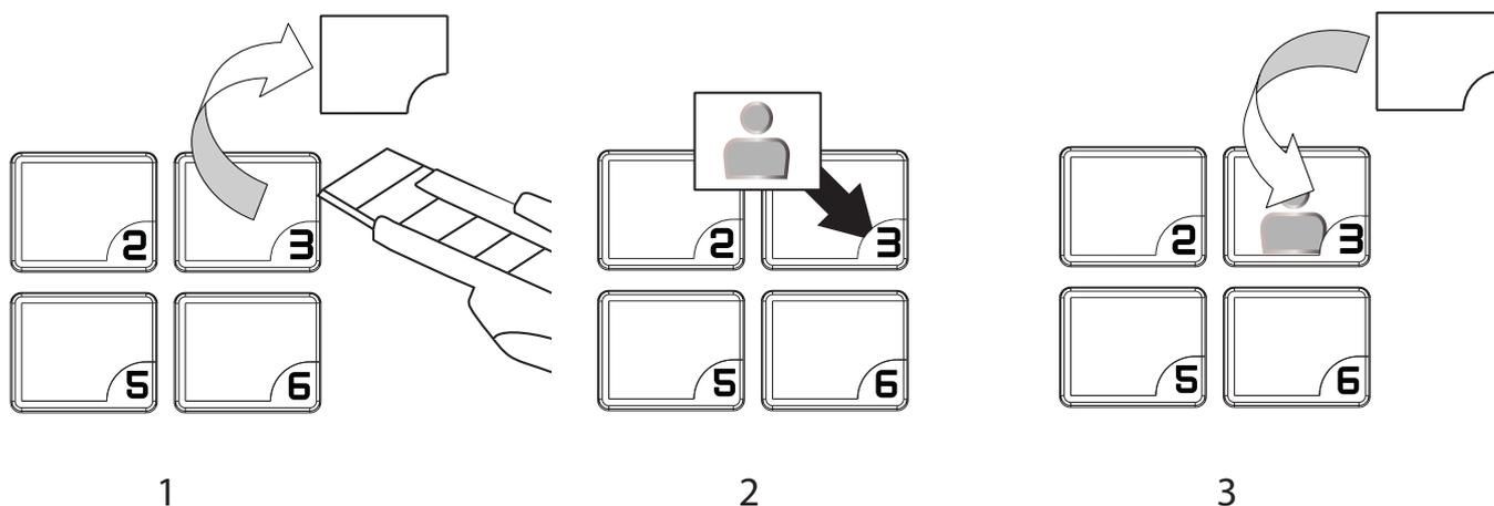
1. Entfernen Sie die durchsichtige Schutzabdeckung mit einem scharfen Gegenstand und entfernen Sie das vorhandene Foto aus der Taste.
